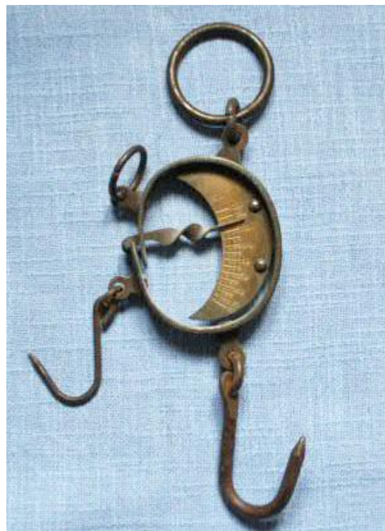
Federwaage links: einfacher Vorläufer der später mit zwei Aufhängepunkten und Gewichtsskalen ausgerüsteten Mond- Sichel- oder Wildwaage rechts
