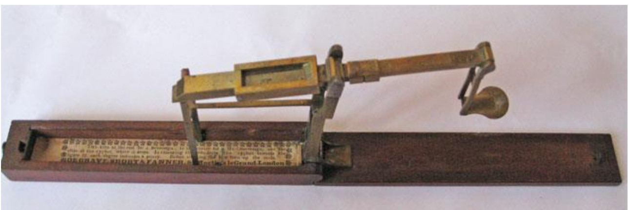
Im edlen Mahagonikasten versenkbare Taschenwaage "Sovereign Guinea Scale London"
