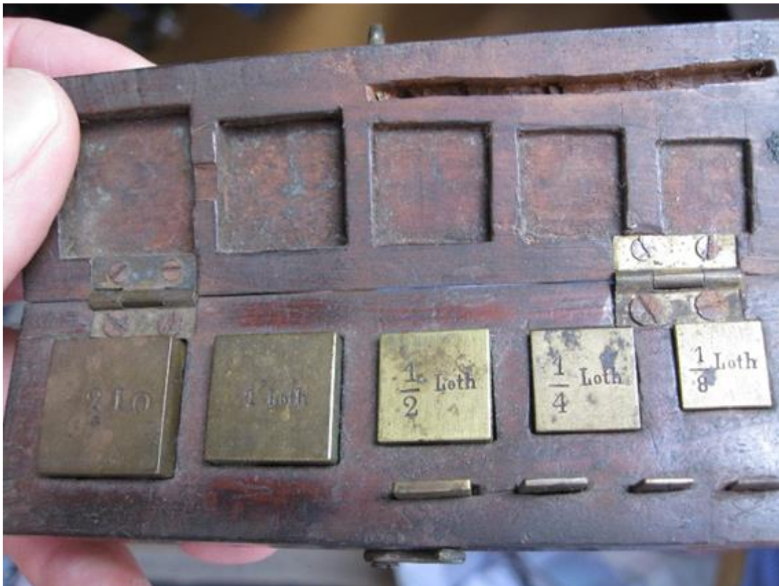
Gewichtskasten mit Lot(h)-Gewichten / Vorläufer der metrischen Masse (1 Lot ca. 14-18 g / völlig ungenau aber leicht zu merken: 1 Loth = 1 Löffel voll)
