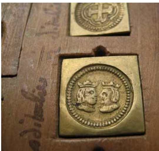
Handwerkskunst zum zweiten: Nahaufnahme Bildergewichte einer Münzwaage aus der Zeit vor 1750
