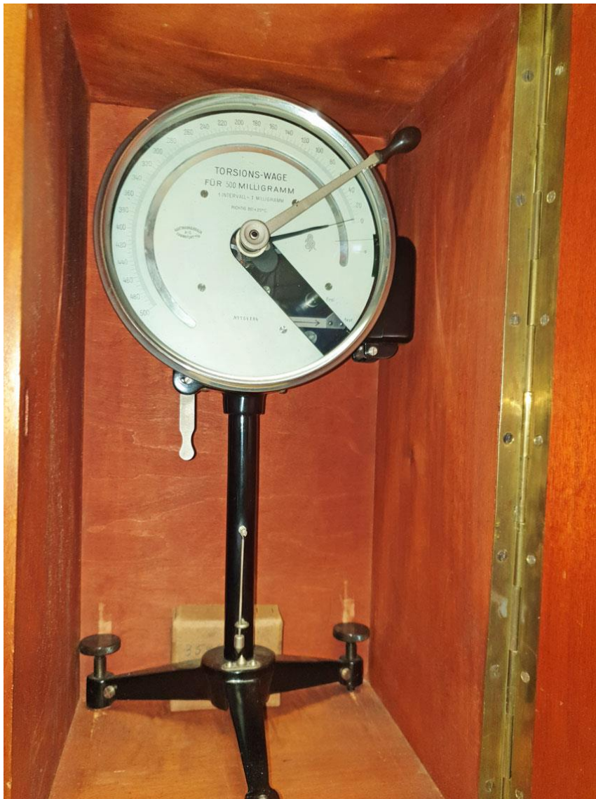
Wikipedia: Eine Torsionswaage oder auch Drehwaage benutzte man seit dem 19. Jahrhundert zur Messung sehr kleiner Kräfte, z. B. der Massenanziehung (Gravitation)
