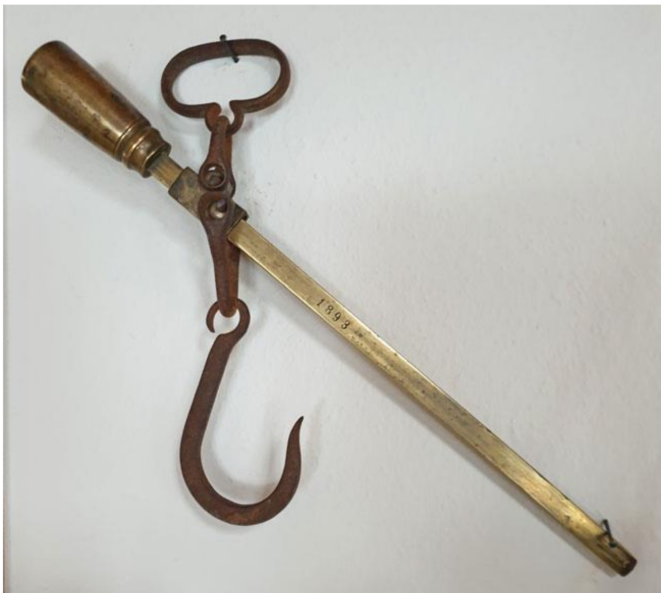
Russisches Laufgewicht oder Besemergewicht Messing (div. Punzierungen / u.a. Jahr 1893)
