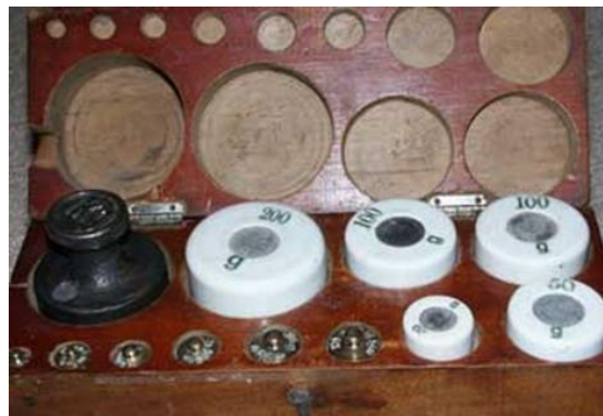
Apothekergewichte (mit Punzen «Wien»: Obolengewichte (oben links mit «Hirschstange»), Gran- Gewichte (unten rechts) und Ausgleichsgewichte (unten links)
