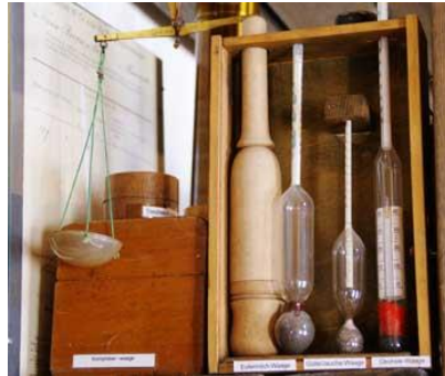
Getreide-, Eutermilch-, Öchsle- und Jauchewaage Taschen-Viehwaage: vom Bauchumfang in cm zum Gewicht des Kalbes!
