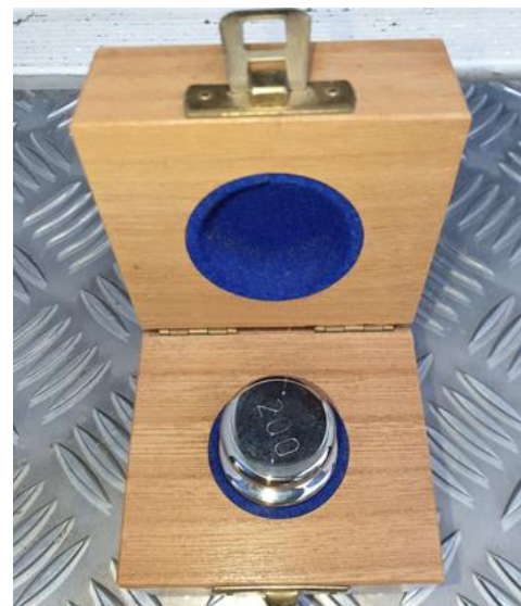
Kalibriergewicht 200 g der Firma Mettler-Toledo / «Messunsicherheit 2.7 mg» Geschenk von Franz Blöchliger, Wald
