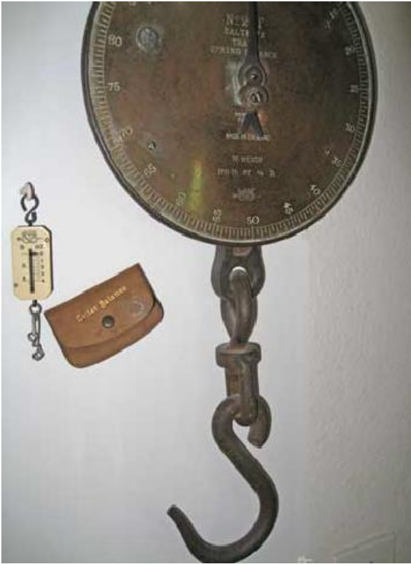
2 x Salter England: Briefwaage bis 1/4 Unzen (5g) rechts Gewerbe u. Industriewaage bis 100 lb (35kg)
