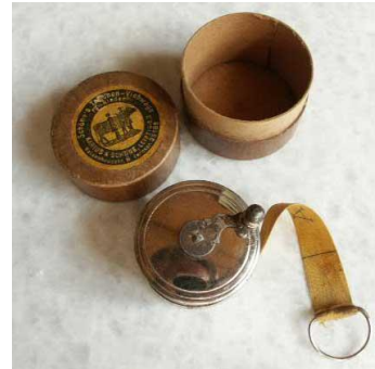
Getreide-, Eutermilch-, Öchsle- und Jauchewaage Taschen-Viehwaage: vom Bauchumfang in cm zum Gewicht des Kalbes!
