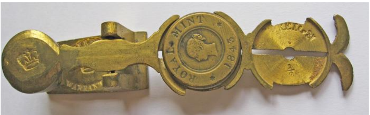
Englischer Münzprüfer als Nachfolge und mobilere Lösung der aufwändigen Münzwaagen
