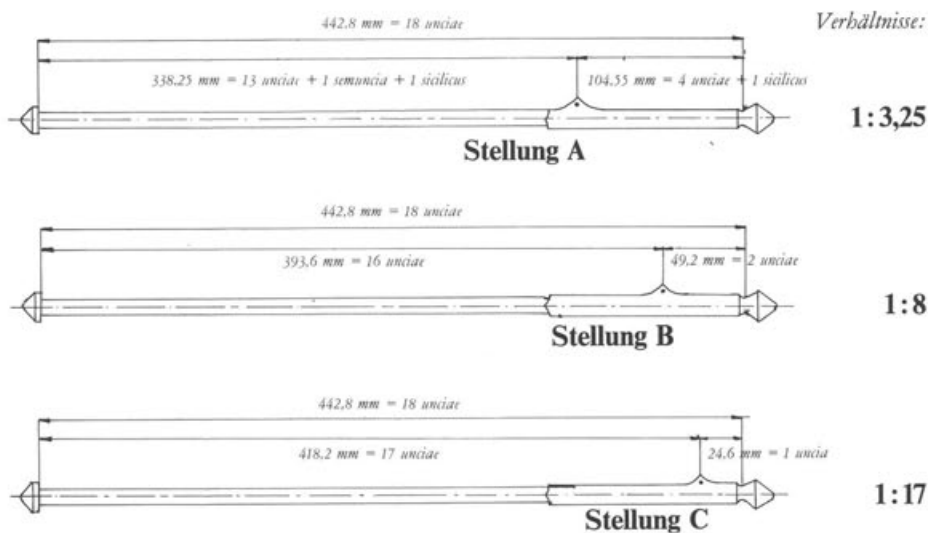
Abb. 12 Grosse römische Schnellwaage aus dem Kunsthandel (Abb. 13). Vgl. Anmerkung 10 und Kommentar zu Abb. 10.
